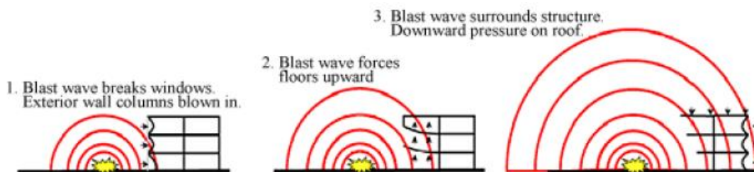
شکل ۳. پخش شدن موج انفجار روی ساختمان [۲۲]
