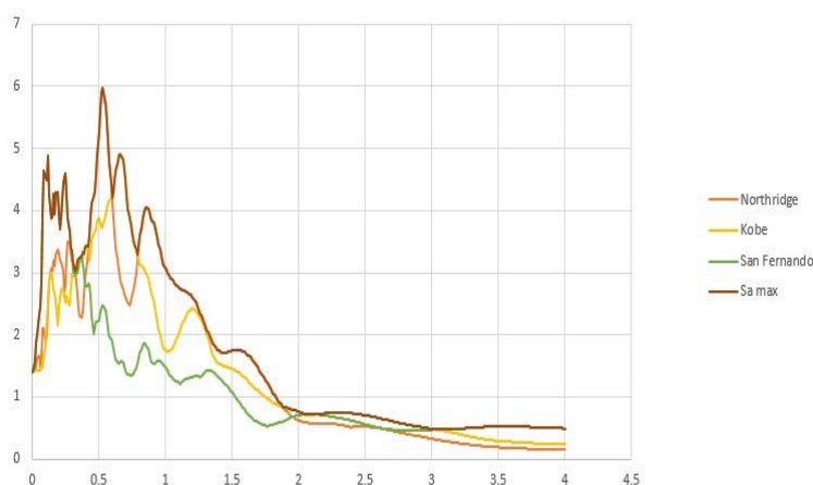
شکل ۵. طیف پاسخ حداکثر ۳ شتاب نگاشت ترکیبی با میرایی ۵٪
