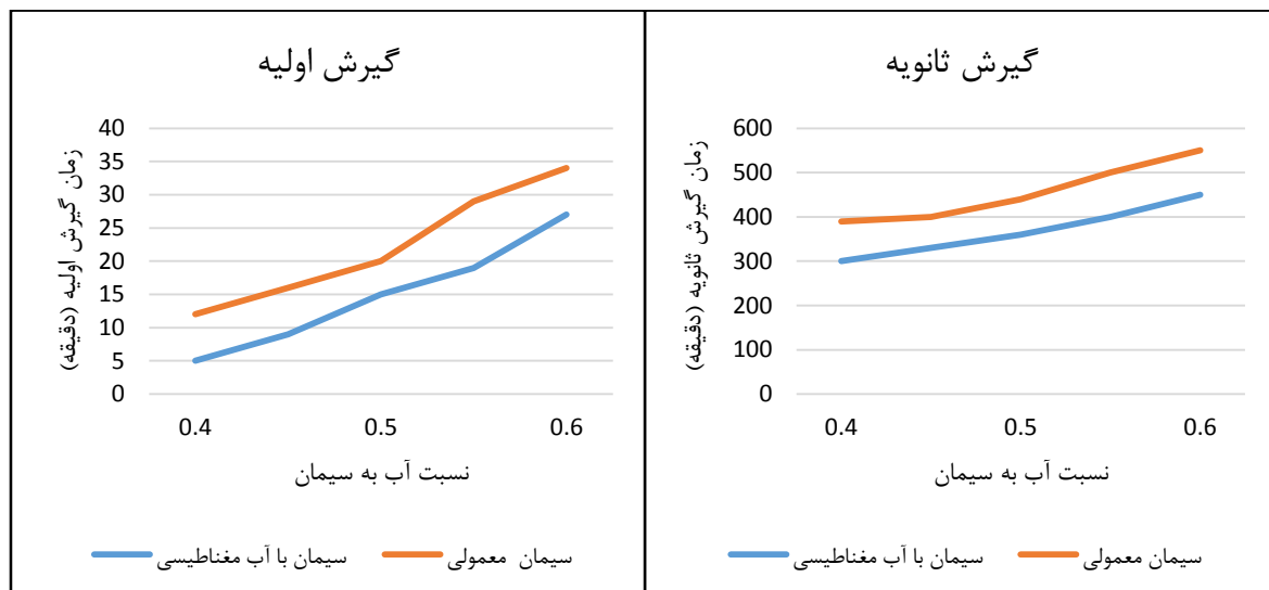
شکل ۶. تغییرات گیرش اولیه و ثانویه خمیر سیمان با آب مغناطیسی و خمیر سیمان معمولی با نسبت آب به سیمان
