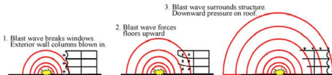
شکل ۳. پخش شدن موج انفجار روی ساختمان [۲۲]
